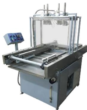
**Машина смазки противней МСР-2** предназначена для нанесения антипригарной смазки на противни, формы и прочий кондитерский инвентарь для выпечки. 4 регулируемые форсунки равномерно распыляют смазку на растительной или восковой основе. Оператор устанавливает противень на машину и конвейер переносит противень в зону опыления. Большое количество регулировок позволяют подобрать оптимальные режимы работы оборудования.
