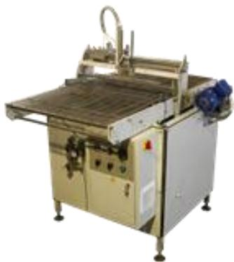
**УЗО-2** – автоматизированный узел опыления, предназначенный для нанесения клеевых составов, сиропов и прочих жидкостей на поверхность изделий, коржей и прочего. Машина изготавливается под конкретное техническое задание заказчика и может иметь огромное количество опций и модификаций. Например:
